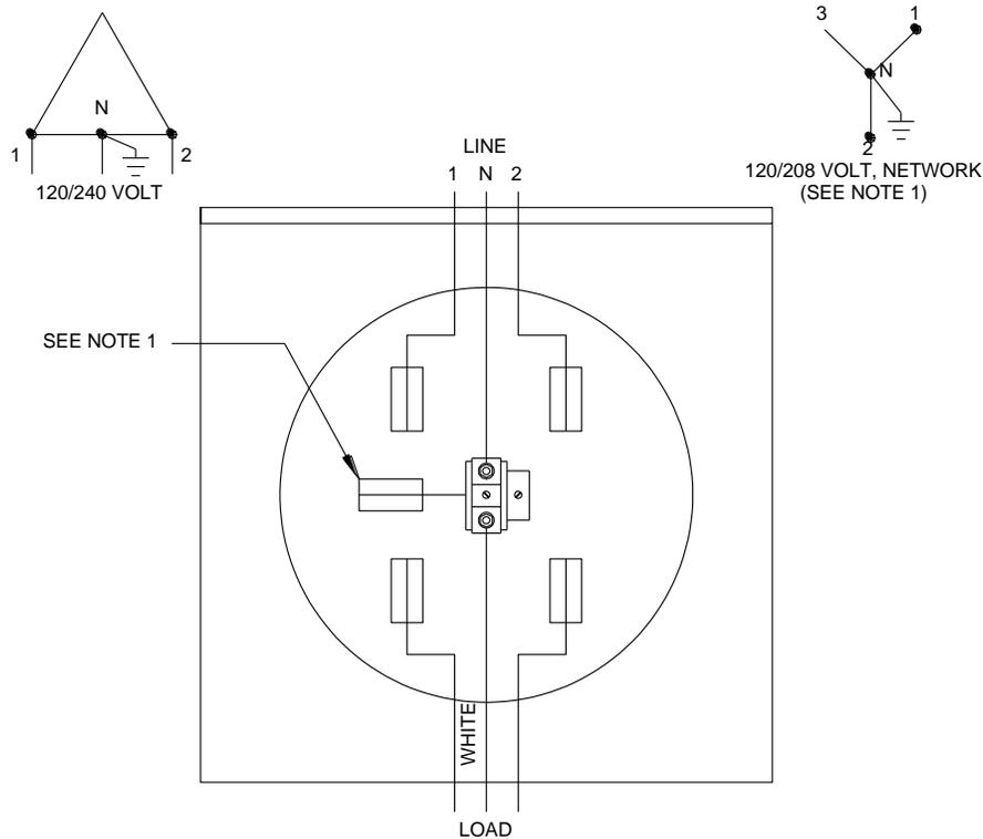
Figure 12.1 Meter Socket Wiring Diagram
